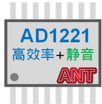
AD1221 支持風扇最低轉停轉/最低轉速設置、PWM 低占空比設置、斜率調整、FG(1/2FG) & RD 設置、PWM/VSP 控制訊號設置、緩啟動設置、馬達轉向容錯設置...等常用風扇規格，功能強大且容易上手，其應用線路相當精簡，為 12V/24V 風扇提供一個最佳的升級方案。
